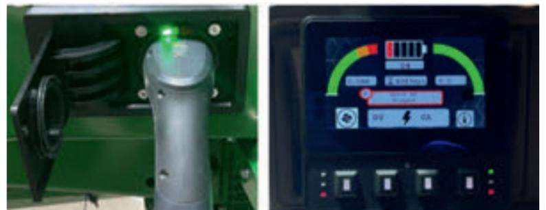
L'interface d'affichage de recharge pour l'utilisateur se situe dans la cabine, tandis que la prise de recharge type T2 est à l'extérieur du tracteur. © In Situ
