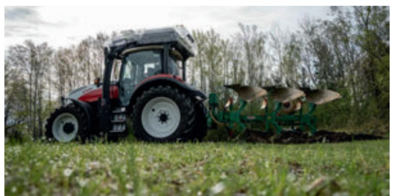
Le Steyr Fctrac, basé sur le châssis du 4140 Expert CVT, est un concept équipé d'une pile à combustible à hydrogène et d'une batterie alimentant un moteur électrique. © Steyr
