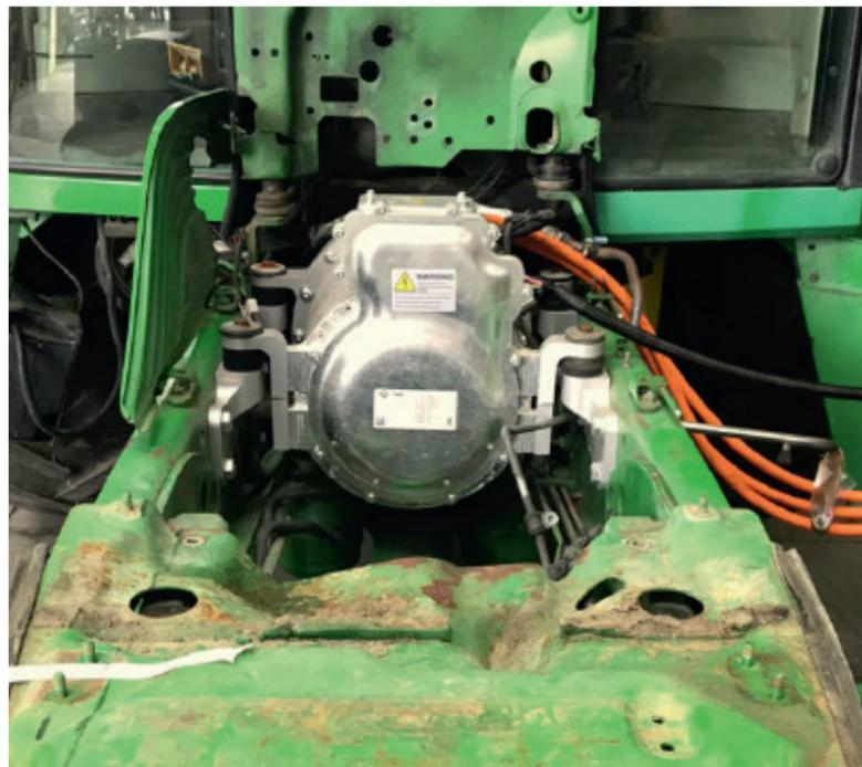
Le moteur électrique est directement couplé à la transmission d'origine du tracteur. © In Situ
